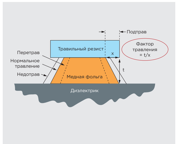
Определение фактора подтравливания проводников печатных плат
