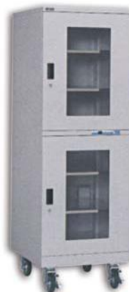
Рис. 4. Мобильное исполнение шкафов сухого хранения позволяет доставлять электронные компоненты и печатные платы непосредственно на участок монтажа. Это обстоятельство позволяет минимизировать время нахождения электронных компонентов в неконтролируемых с точки зрения поддержания влажности условиях.
