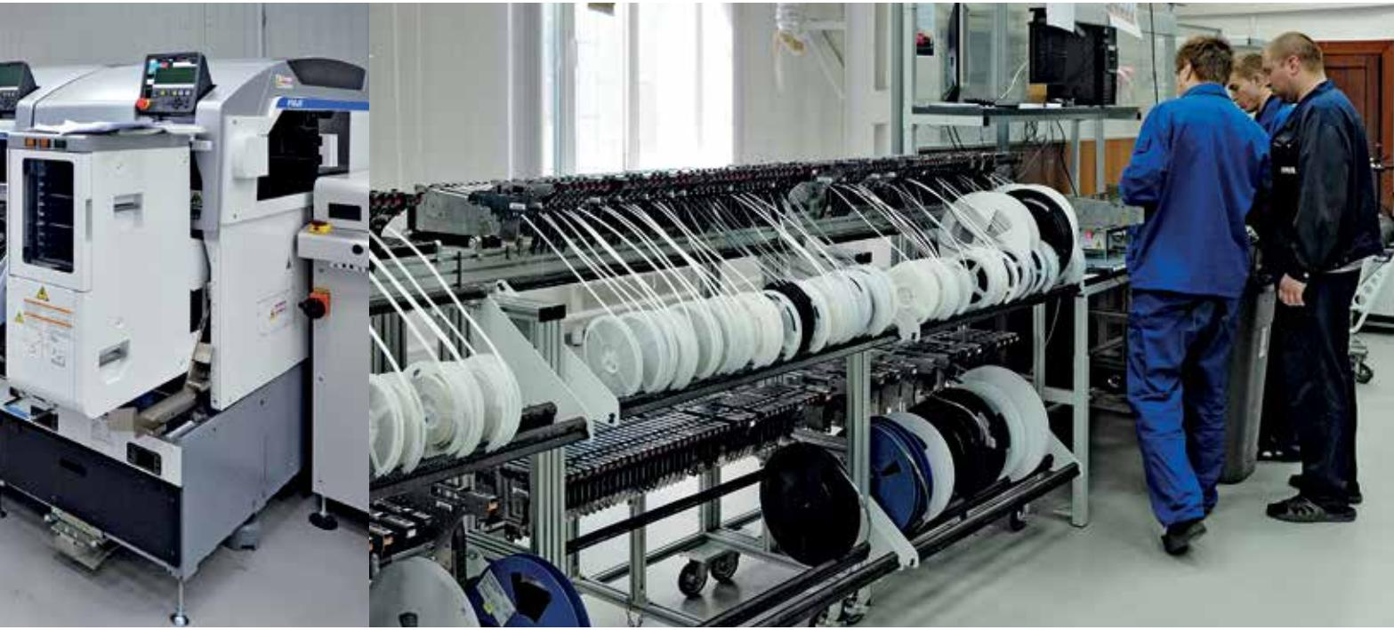
достаточно стандартна. Платы помещаются в магазинный загрузчик (компании Nutek), из него подаются в трафаретный принтер DEK Horizon 03IX. И тут — первая особенность: после принтера установлен автомат оптической инспекции Viscom S3088 SPI, контролирующий точность нанесения пасты. Мы не стали использовать трафаретный принтер со встроенным модулем оптической инспекции, так как он работает медленнее, чем два независимых устройства.
