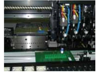
Рис. 15 Процесс установки деталей Lego с помощью SM451
