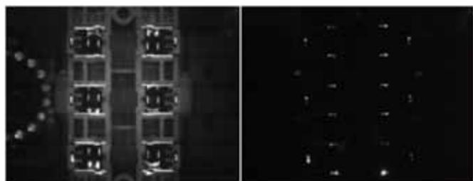
Рис. 9 Выводы штырьевого компонента при штатной подсветке (слева) и лазерной подсветке (справа)
