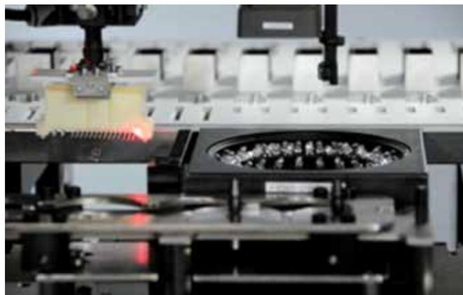
Рис. 10 Камера центрирования с функцией контроля плоскостности выводов
