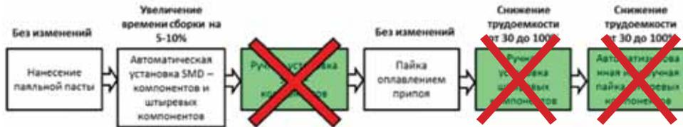
Рис. 13 Изменения в технологическом процессе после внедрения автомата SM-451
