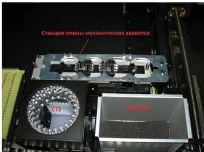
Рис. 4 Автоматическая станция смены механических захватов (Grippers) с гнездами под них
