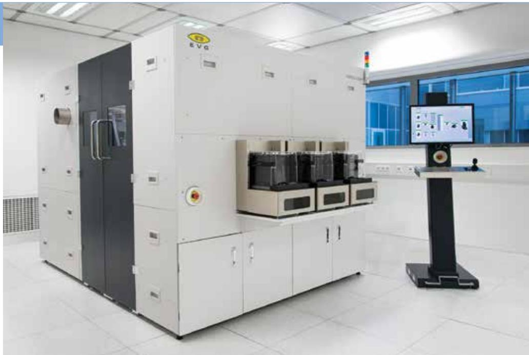
рованные решения для массовых производств, обеспечивающих непревзойденную производительность (40 пластин диаметром 200 мм в час). Система построена на базе модульной платформы, которая позволяет использовать разнообразные материалы и получать структуры широкого диапазона размеров, обеспечивая гибкость при решении производственных задач, а полностью закрытая конструкция минимизирует риск загрязнения.
