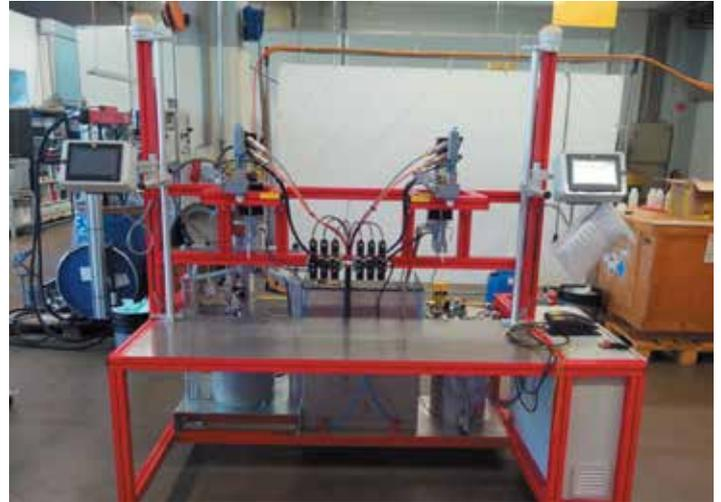
**2** Система дозирования Dorag Metamix Special для работы с материалами Виксинт У-1-18 и Виксинт У-4-21
