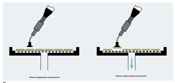
Технология Gel-Pak вакуумной разблокировки изделий
