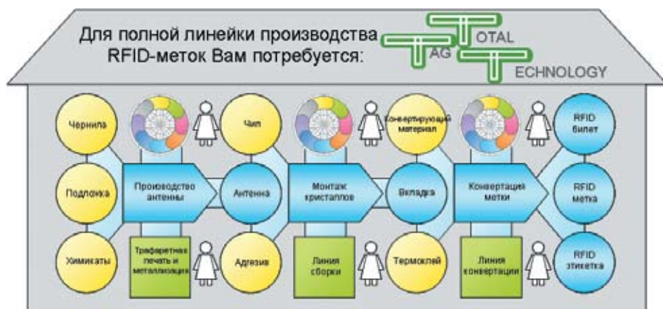
Рис. 3 Линия производства устройств радиочастотной идентификации
